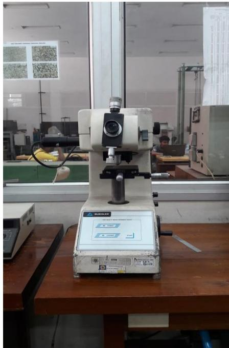
**Gambar 3.38** Alat pengujian kekerasan
