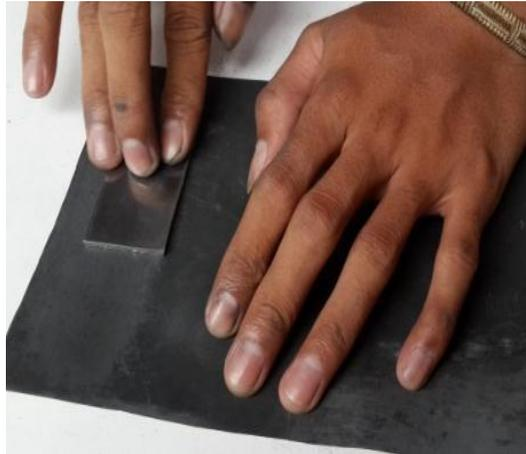
**Gambar 3.28 Proses Pengamplasan Spesimen**
