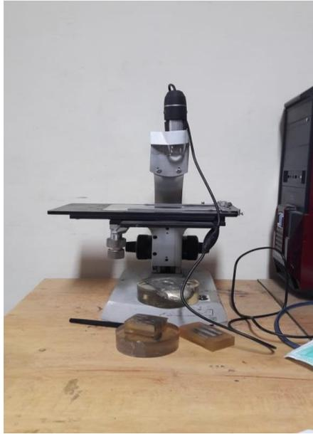
**Gambar 3.37** *Alat pengujian makro*
