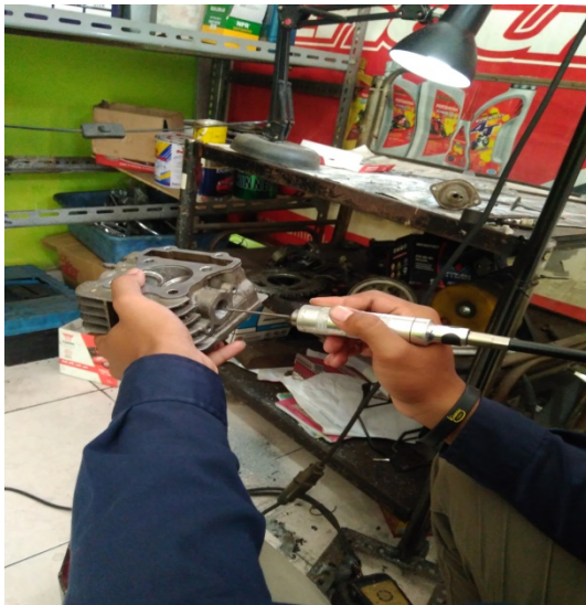
Proses Polish Pada Saluran In Dan Ex
