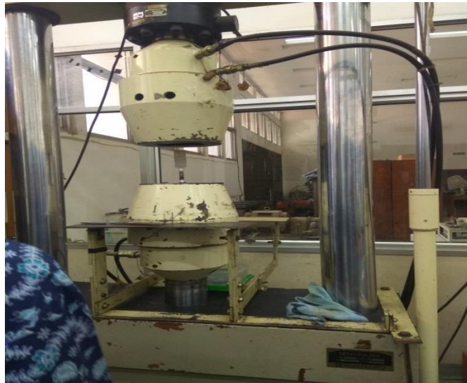
Gambar 2.1 Pemasangan Spesimen Pada Ragum
