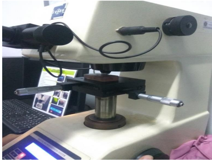
Gambar 4.3 Pemasangan Bahan Pada Alat Uji Kekerasan
