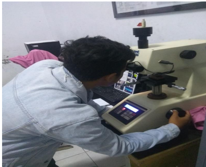
Gambar 4.4 Proses Pengujian Kekerasan
