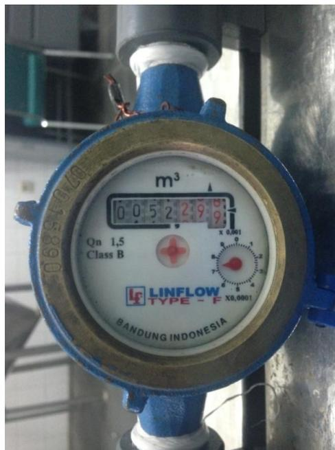
**Gambar 4.3.** Meter Air Uji
