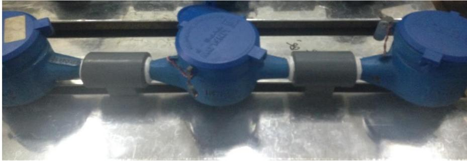
**Gambar 4.2 .Meter Air Posisi Tegak (Vertikal)**
