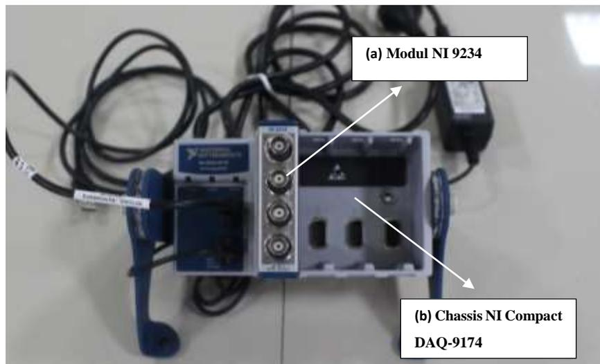
Gambar 3. 11 Perangkat Akuisisi Data (a) Modul NI 9234, pada (b) chassis NI Compact DAQ-9174
