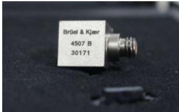
Gambar 3. 9 *Accelerometer*
