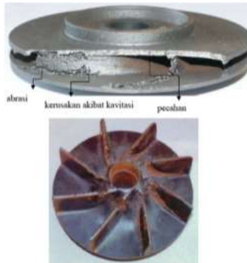
Gambar 2. 3 Kerusakan impeler pompa karena kavitas
