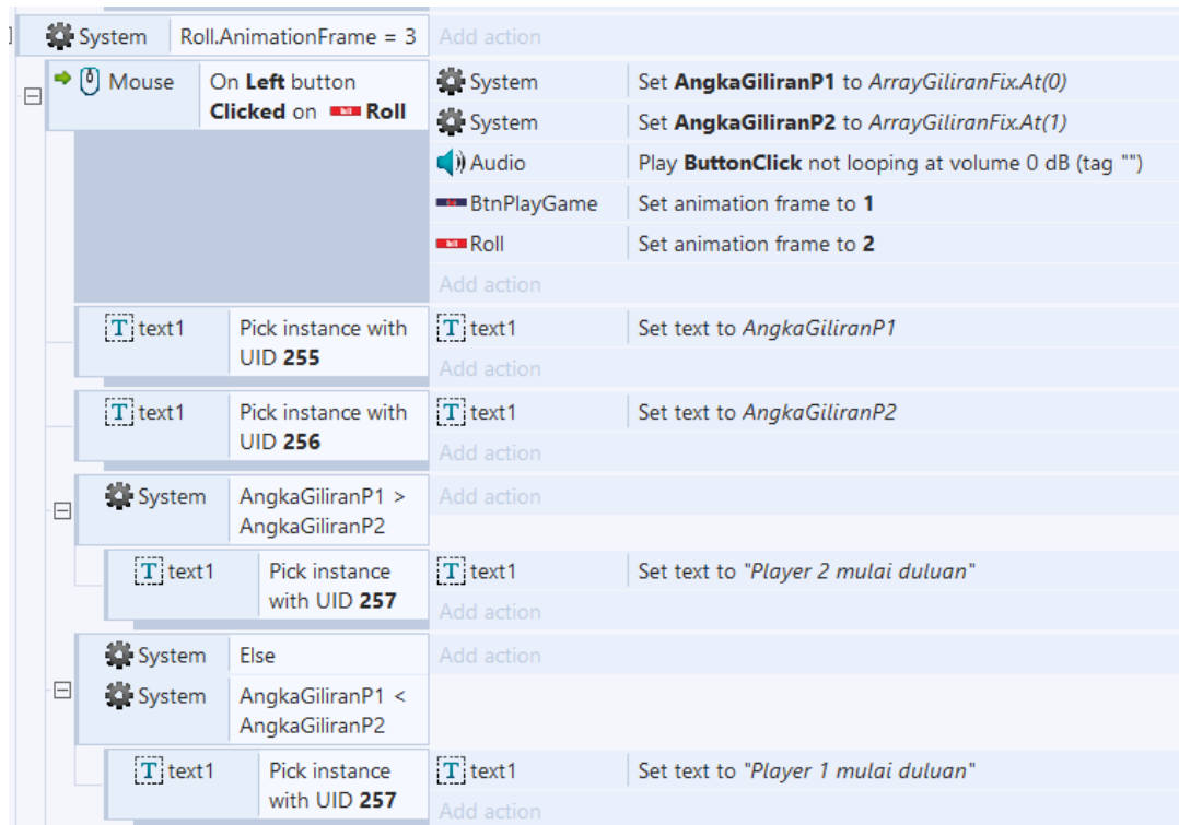
Gambar 4.39 Source code ketika tombol roll ditekan pada preparation game
