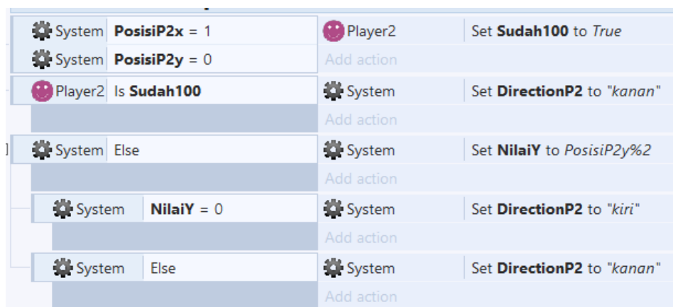
Gambar 4.57 Source code menentukan variable direction untuk pemain 1
