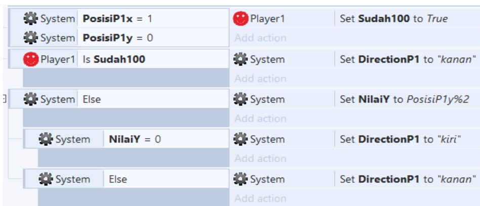
Gambar 4.57 Source code menentukan variable direction untuk pemain 1
