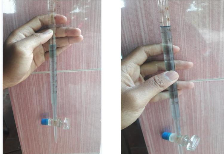
Sebelum Pemotongan silinder 17,1 ml. Sesudah Pemotongan Silinder 15,1 ml
