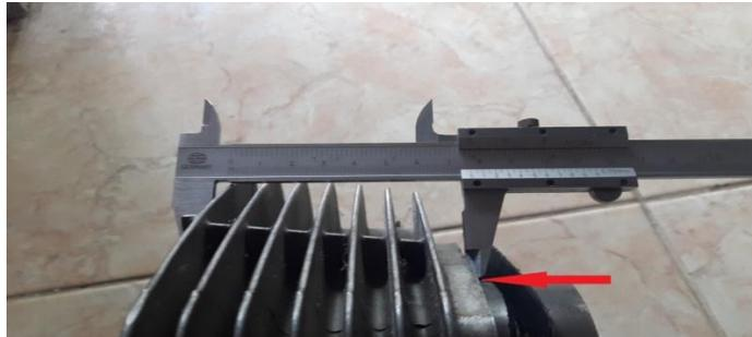
Gambar 3.5. Sebelum pemotongan blok silinder 1 mm
