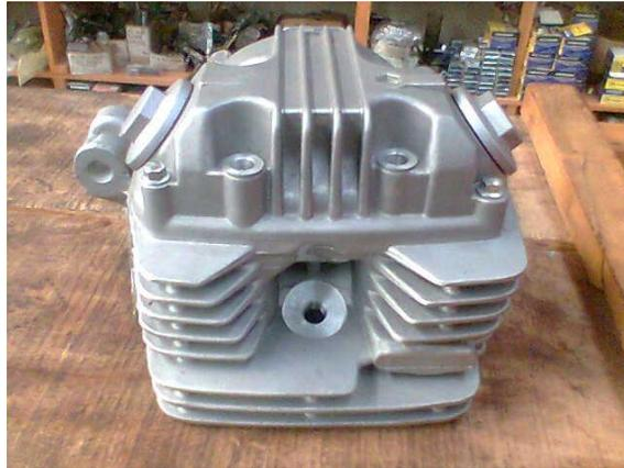
Gambar 2.10. Kepala Silinder (*cylinder head*)
