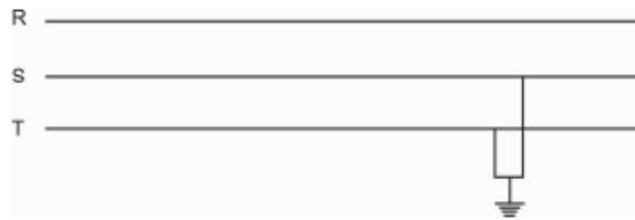
Gambar 2. 7 Gangguan 2 fasa ke tanah
