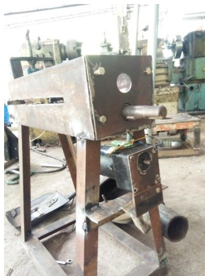
1.9 Gambar braket bantalan poros gigi dan braket motor listrik
