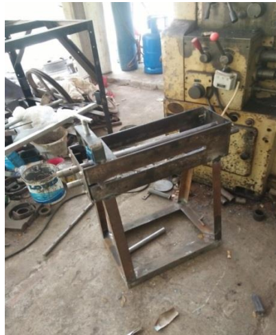
1.6 Gambar pembuatan penyangga mesin
