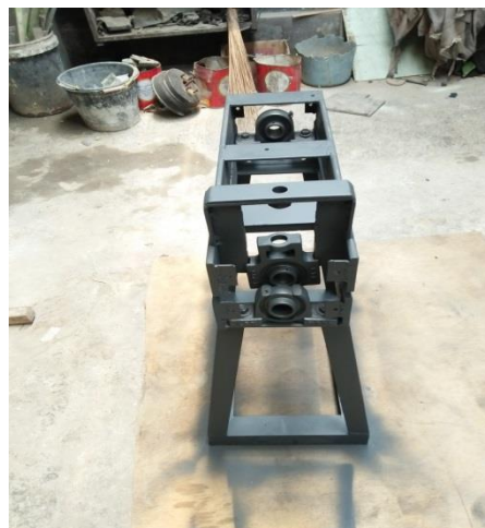
4.11 Gambar proses e-poxy pada kerangka dan braket Bead Roller
