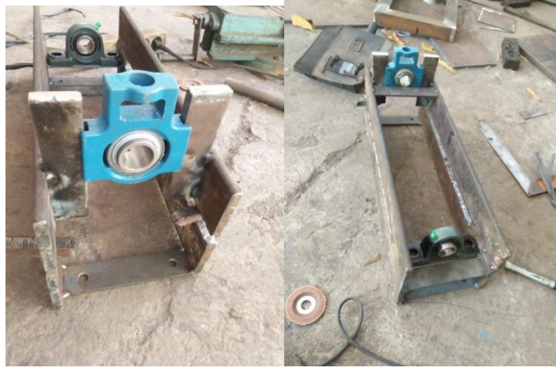
4.4 Gambar pembuatan kerangka mesin Bead Roller
