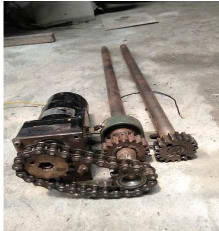
1.10 Gambar dudukan roda gigi dan gigi sproket
