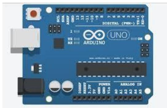
Gambar 2. 4. Modul arduino
