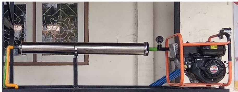
Gambar 3.2 Rangkaian pipa pada mesin pengolahan air
