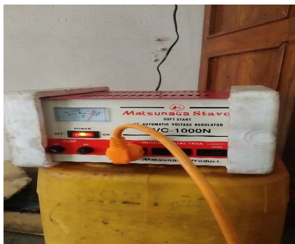
Gambar 4.17 Pemasangan Kabel Ke Stafol
