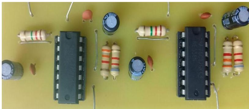
Gambar 4.14 Pemasangan Komponen Penyusun Alat *Timer*
