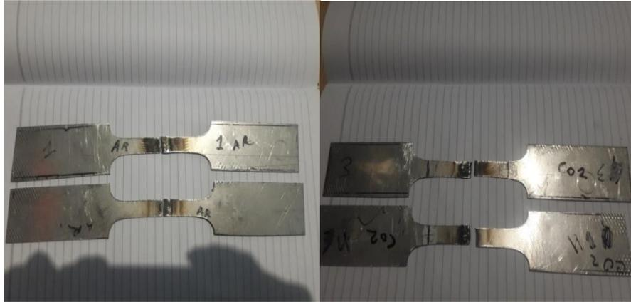
**Gambar 4.3** Spesimen setelah dilakukan pengujian tarik (kiri) gas argon (kanan) gas  $CO_2$
