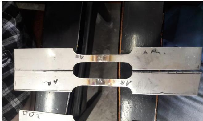
**Gambar 4.1** *Spesimen pengujian tarik gas pelindung argon*
