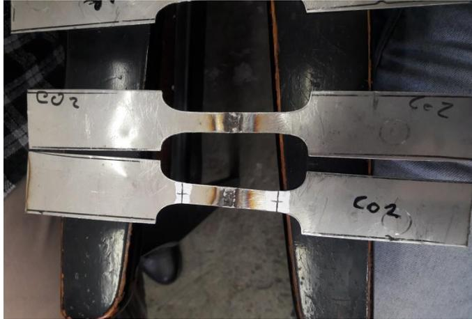
**Gambar 4.2** *Spesimen pengujian tarik gas pelindung CO<sub>2</sub>*
