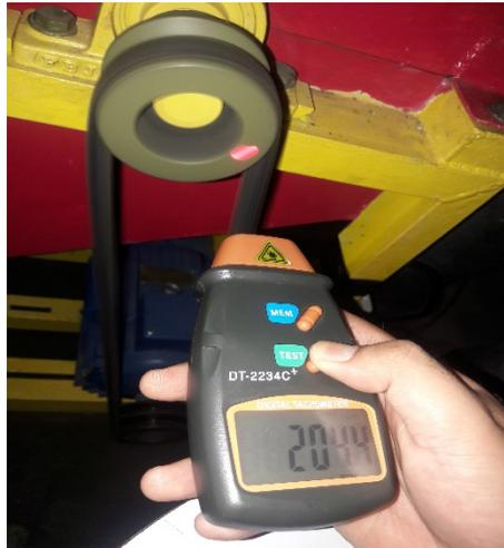
Gambar 4.4 Pengukuran Putaran Puli Poros Mata Pisau dengan *Digital Photo Tachometer*
