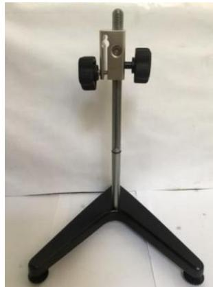
Gambar 3.20 Rangkaian penyangga viskometer
