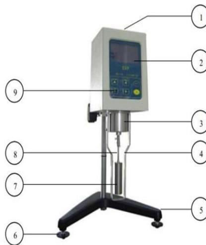
Gambar 3.12 Rangkaian komponen *viscometer*
