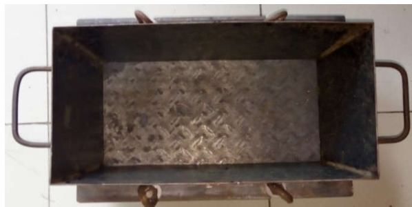
Gambar 3.2 Box cetakan benda uji tampak atas
