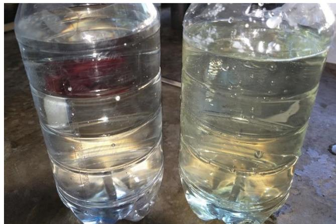
**Gambar 4.1** Air bersih dan air setelah dilakukan sirkulasi dengan asam klorida
