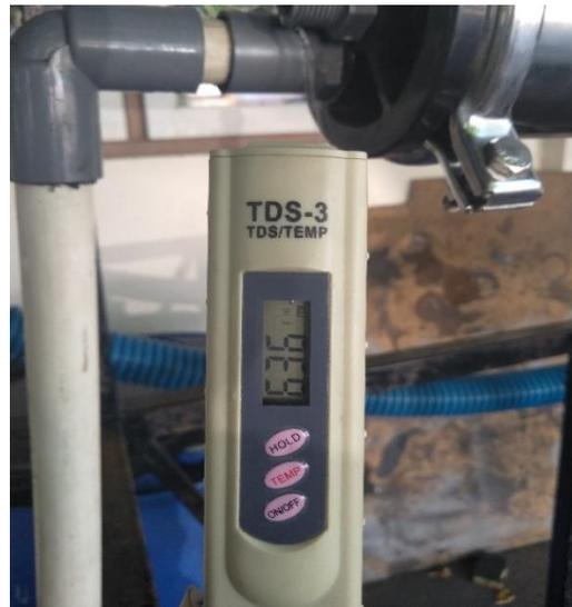
**Gambar 4.6** Hasil TDS setelah di filtrasi melewati membran *reverse osmosis*
