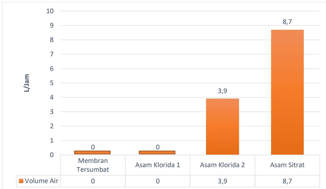
**Gambar 4.3** Grafik volume air pada membran *reverse osmosis* pada tiap pengujian
