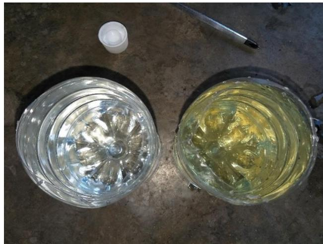
**Gambar 4.2** Air bersih dan air setelah dilakukan sirkulasi dengan asam sitrat
