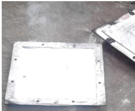
Gambar 4.1 Cetakan logam ( Die Casting )
