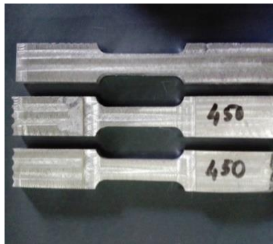
Gambar 4.5 Spesimen uji tarik sebelum di uji
