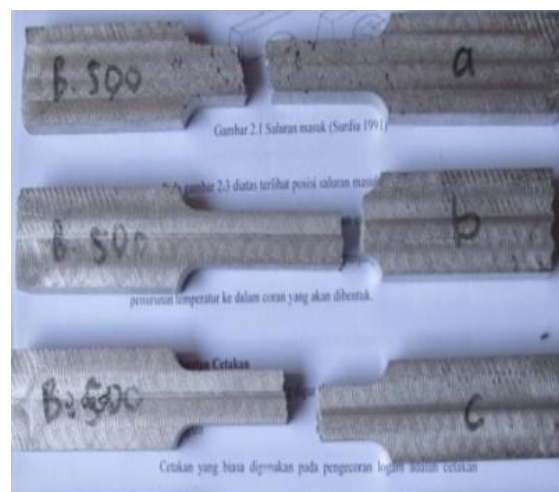
Gambar 4.6 Spesimen uji tarik setelah di uji
