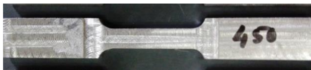
Gambar 3.6 Spesimen uji tarik standar ASTM E8M
