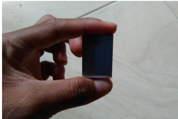
Gambar 3.4 Spesimen untuk uji stuktur mikro
