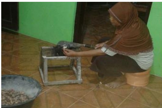
Gambar 2. Pengupasan mete menggunakan Kecip
