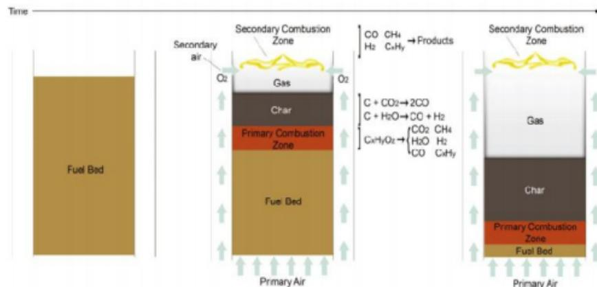
**Gambar 2.3** Skema Gasifikasi Metode Top-Lit Up Draft
