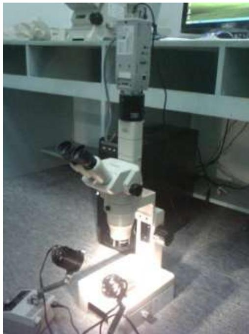
**Gambar 0.11** Mikroskop Stereo untuk Foto makro
