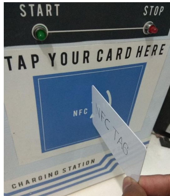
Gambar 4.25 NFC Tag Horizontal dengan sudut 90 Derajat Terhadap Modul PN 532
