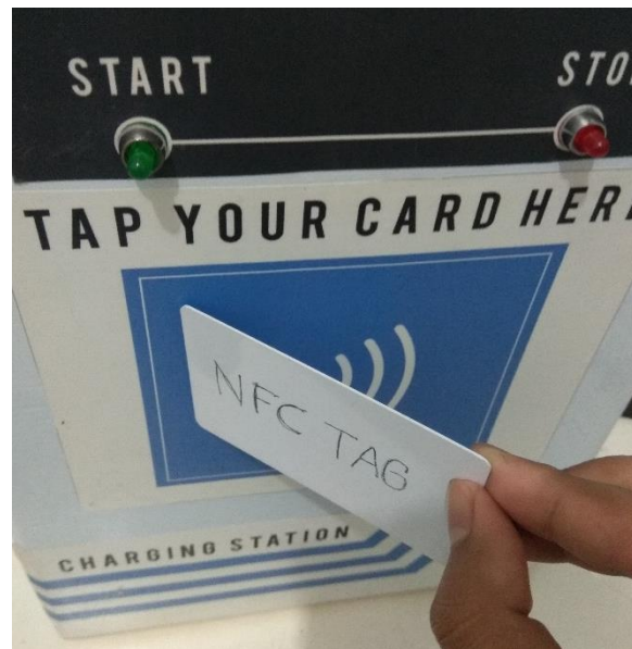
Gambar 4.23 NFC Tag Horizontal dengan sudut 45 Derajat Terhadap Modul PN 532
