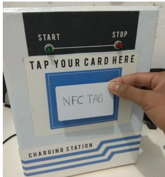
Gambar 4.19 NFC Tag Horizontal Terhadap Modul PN 532
