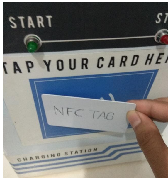
Gambar 4.22 NFC Tag Horizontal dengan sudut 30 Derajat Terhadap Modul PN 532
