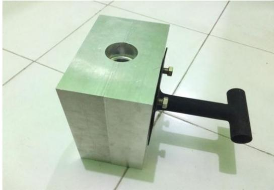
Gambar 4.4. Memasang kedua sisi mold
