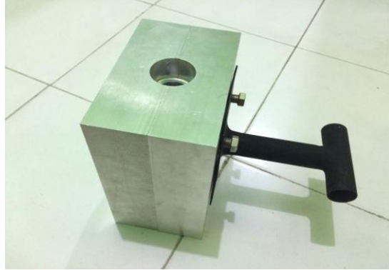
Gambar 4.19. Memasang kedua sisi mold
