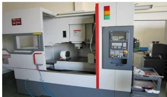
Gambar 3.4. Mesin CNC Vertikal M/C MV184
