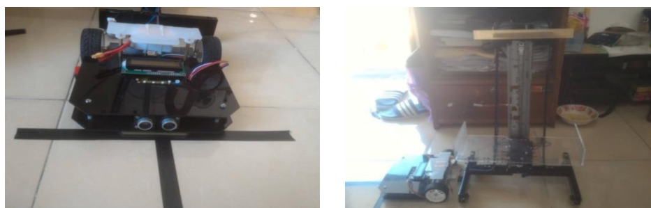
Gambar 4.6 Pengujian Robot Line Follower dan Trolley Otomatis.
