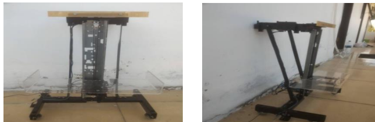
Gambar 4.4 Hasil Proses Pembuatan dan Perakitan Trolley .
