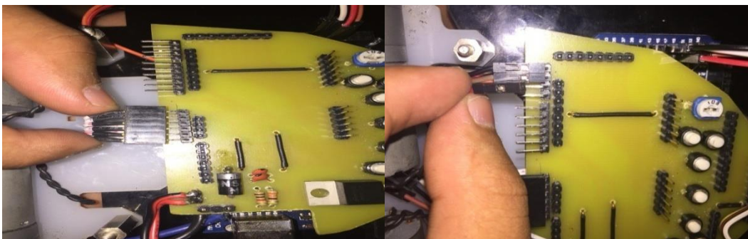
Gambar 4.31 Pemasangan Kabel Jumper Ke Board PCB.
