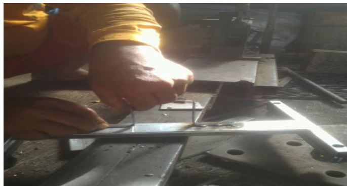
Gambar 4.14 Pengelasan Dudukan Dibagian Trolley .
