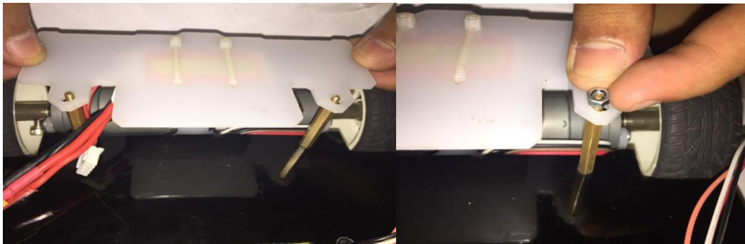
Gambar 4.36 Pemasangan Dudukan Baterai ke Mur Spacer.
