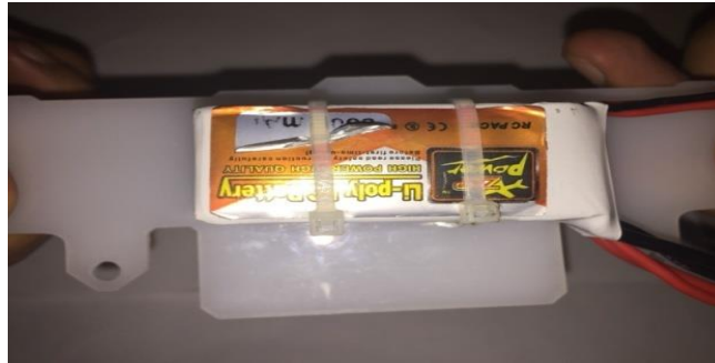
Gambar 4.35 Pemasangan Kabel Ties ke Dudukan Baterai.
