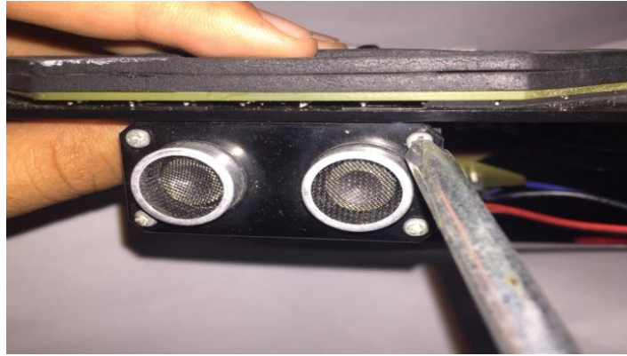
Gambar 4.27 Pemasangan Dudukan Sensor Ultrasonik HC SR-04.
