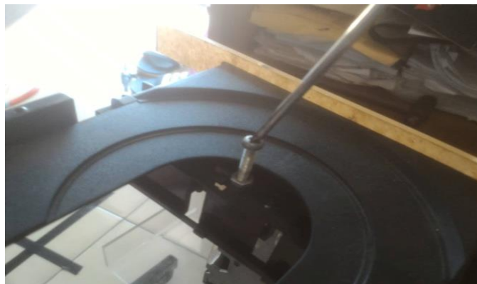
Gambar 4.41 Pemasangan Stopper Pendorong Barang.
