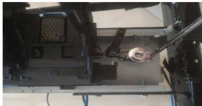
Gambar 4.43 Pemasangan Motor dan Timing Gear .
