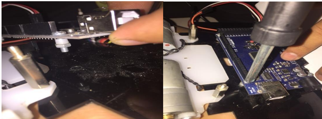
Gambar 4.24 Pemasangan Arduino Atmega 2560 ke Bodi Robot.
