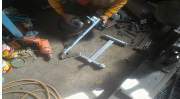
Gambar 4.16 Proses Penghalusan Plat Dengan Gerinda.
