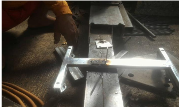
Gambar 4.13. Pembuatan Dudukan dan Pengunci.
