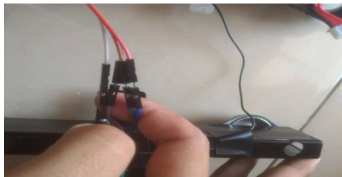
Gambar 4.47 Pemasangan Kabel Jumper Motor Driver ke Kabel Mikrokontroler.
