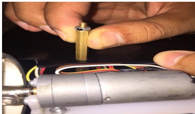
Gambar 4.33 Pemasangan Mur Spacer Bodi Robot Bagian Atas Disisi Belakang.
