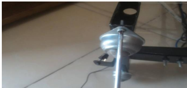
Gambar 4.37 Pemasangan Roda Caster .
