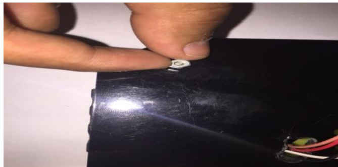
Gambar 4.34 Pemasangan Baut 3mm Pada Bagian Depan Bodi.
