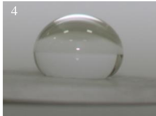
Gambar 9. Mikograf SEM Permukaan Aluminium Hidrofobik Dengan Lama Waktu perendaman 30 jam (1) Struktur morfologi 30 jam perbesaran 5K (2) Struktur morfologi 30 jam perbesaran 10K (3) Struktur morfologi 30 jam perbesaran 20K (4) sudut kontak air pada variasi waktu 30 jam
