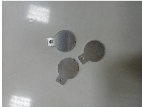
Gambar 3.4 Alumunium yang sudah dipotong menjadi berdiamter 14 mm
