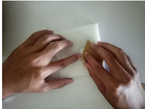
Gambar 3.8 Alumunium yang diampas dari kekasaran 400, 800, 1500
