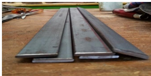
Gambar 3.4 Plat baja karbon rendah ( low carbon )
