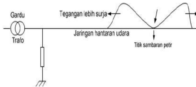
**Gambar 4.4** Penempatan arrester terhadap transformator
