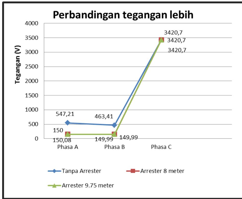
**Gambar 4.40** Grafik Perbandingan *NOD1* tanpa arrester, terpasang arrester 8 meter dan 9.75 meter.
