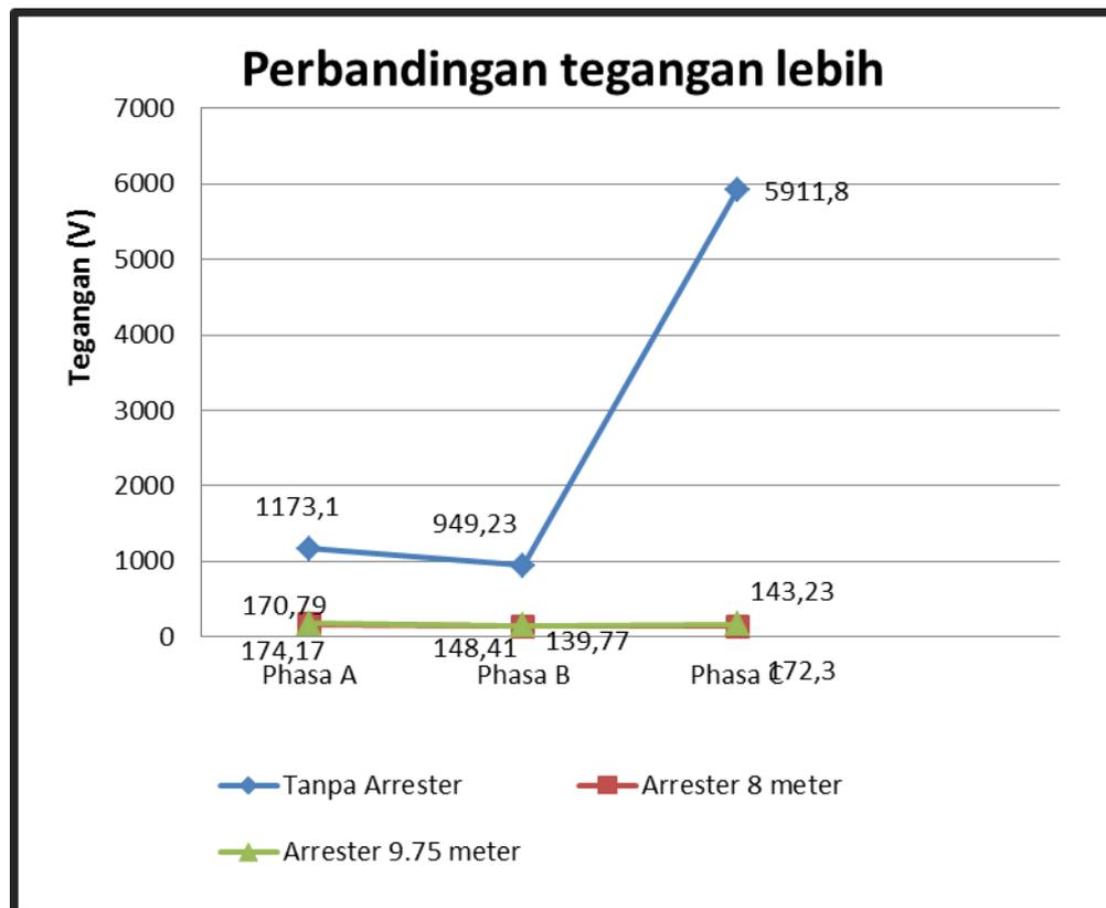
**Gambar 4.42** Grafik Perbandingan *NOD3* tanpa arrester, terpasang arrester 8 meter dan 9.75 meter.
