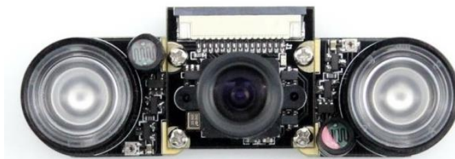
Gambar.2.28. Camera Raspberry Pi NoIR yang dilengkapi dengan lensa, dan IR LED ( https://i.stack.imgur.com/bHwX0.jpg , diakses pada tanggal 22 Juli 2018).
