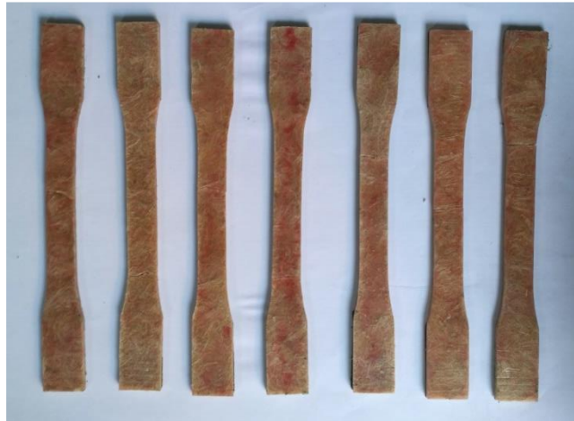
Gambar 3.9. Hasil cetakan yang sesuai dengan ASTM D638-01
