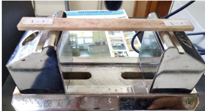
Gambar 3.15. Memasang spesimen pada suport
