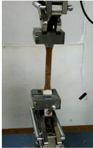
Gambar 3.11. Memasang spesimen pada alat uji tarik
