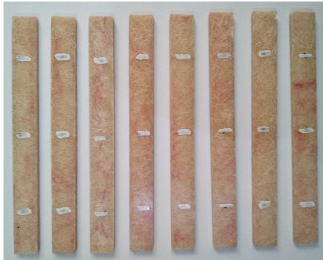
Gambar 3.14. Spesimen yang telah diberi tanda span
