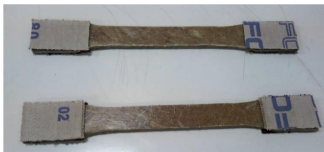
Gambar 3.10. Spesimen yang dipasang amplas dibagian ujungnya
