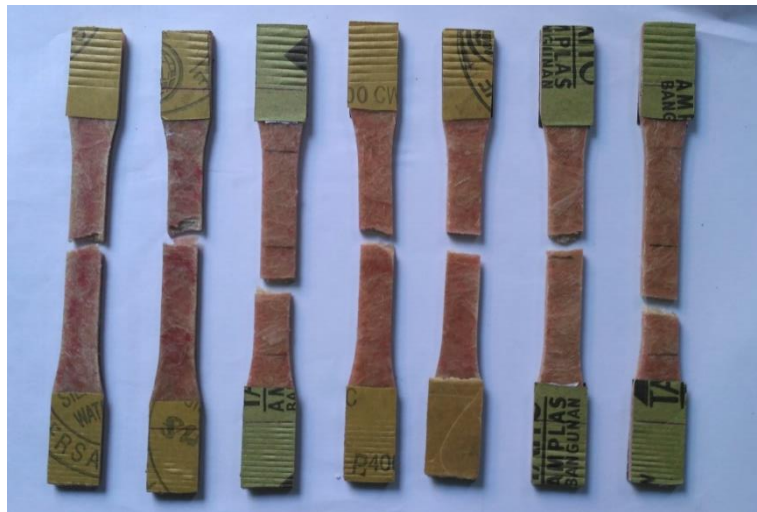
Gambar 3.12. Spesimen yang telah dilakukan uji tarik
