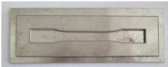
Gambar 3.6. Cetakan spesimen ASTM D638-01
