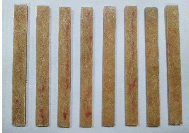
Gambar 3.13. Hasil cetakan yang sesuai dengan ASTM D790-02
