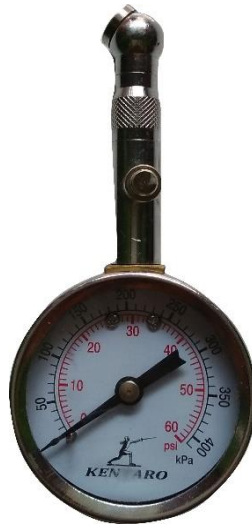
Gambar 3.16 Alat ukur tekanan ban
