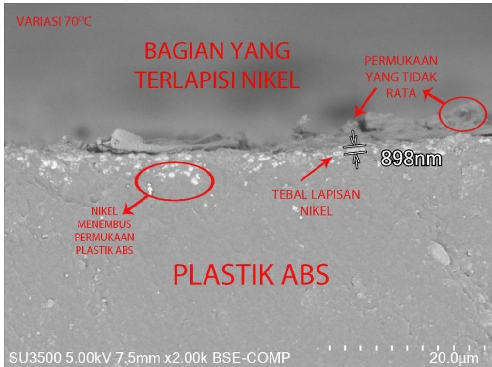
Gambar 4.9 Foto hasil uji SEM pada spesimen dengan suhu elektroless 70°C
