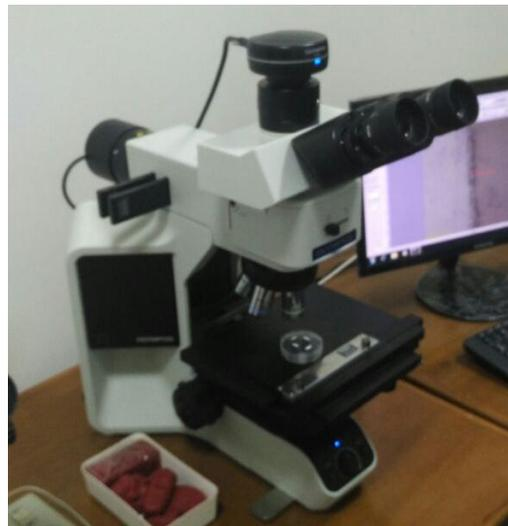
Gambar 3.12 Alat uji struktur mikro
