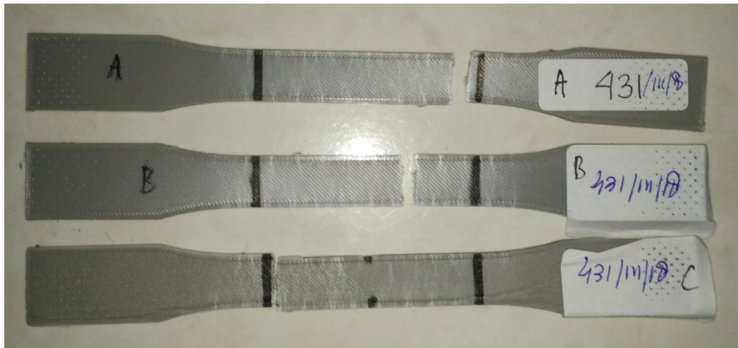
Gambar 4.17. Spesimen eksperimen konfirmasi setelah uji tarik
