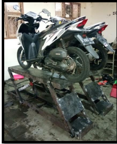
Gambar 4.12 Pengujian angkat beban sepeda motor
