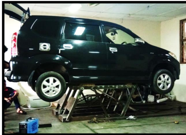
Gambar 4.13 Pengujian angkat beban mobil
