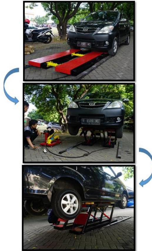
Gambar 4.18 Proses PEHJ mengangkat mobil
