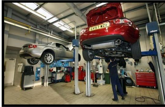
Gambar 2.2 Servis mobil menggunakan *Car Lift*
