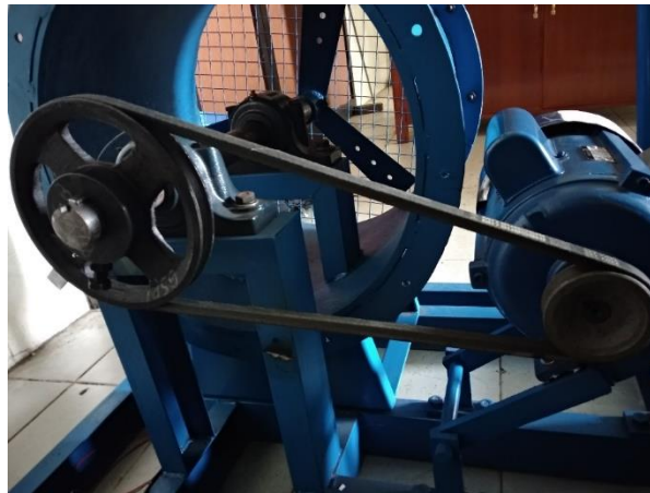
Gambar 3.18 Belt-Pulley antara Motor Listrik dan Fan Aksial
