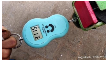
Gambar 4. 8 gambar hasil pengukuran torsi 4 : 1 dengan timbangan tarik
