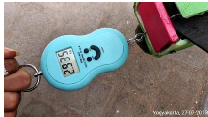
Gambar 4. 7 gambar hasil pengukuran torsi 3: 1 dengan timbangan tarik
