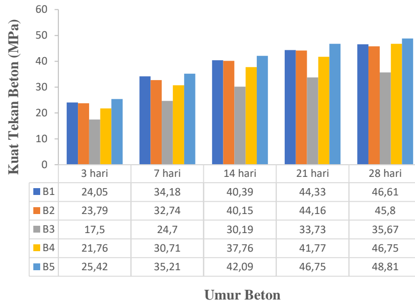
Gambar 2.5. Hasil uji kuat tekan beton benda uji B1, B2, B3, B4 dan B5 (Asri dan Nisumanti, 2014)
