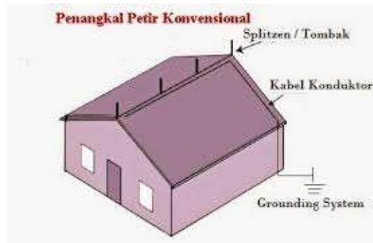
Gambar 2. 27 Penangkal petir metode Franklin Rod
