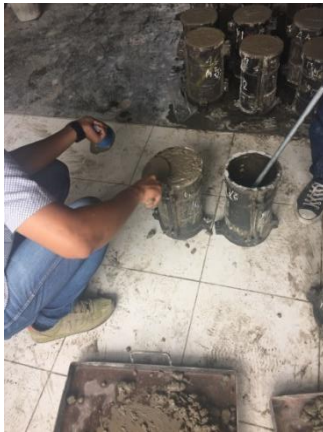
Gambar 28. Proses pembuatan benda uji tekanke dalam cetakan
