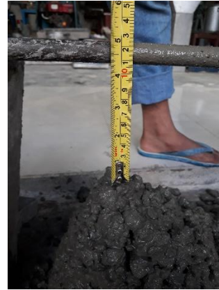
Gambar 27. Proses Pengujian Slump
