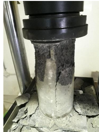
Gambar 29. Proses pengujian kuat beton
