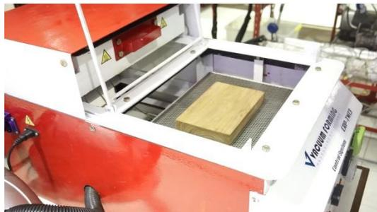
**Gambar 5.** Pemasangan  *mold*
